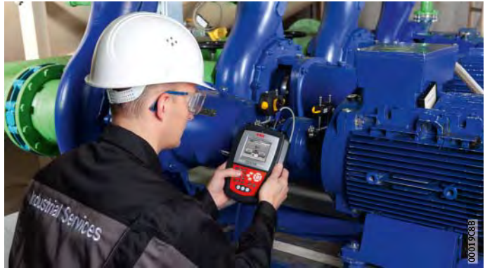
Figura 3 Dispositivo de alineación de ejes Top-Laser EQUILIGN
