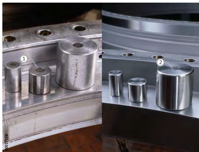
Figura 7 Las pistas de rodadura y los rodillos de rodamiento antes y después del reacondicionamiento
