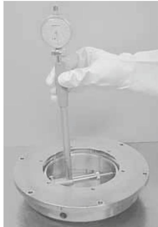
Fig.1.11 Ajuste el Diámetro Inscrito del Calibrador GN
